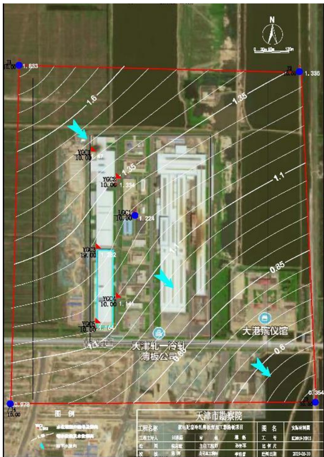
图 3-6 地下潜水流场图
