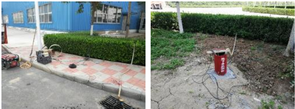
图 3-2 抽水试验照片
