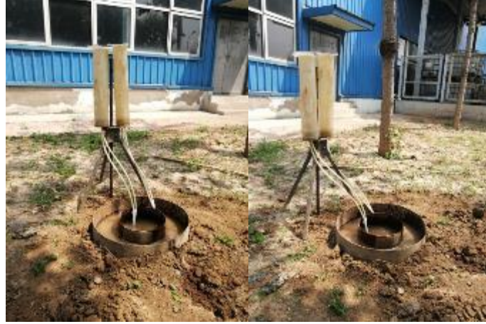
图 3-4 渗水试验照片
